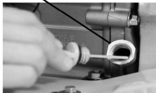
SI. 5 –Proveravanje nivoa ulja u menjaču
