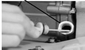
Fig 5a - Verificare ulei motor
