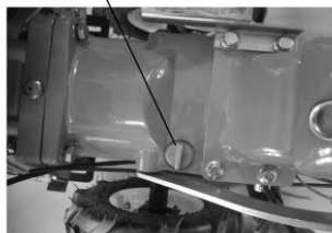
SI. 5 –Proveravanje nivoa ulja u menjaču
